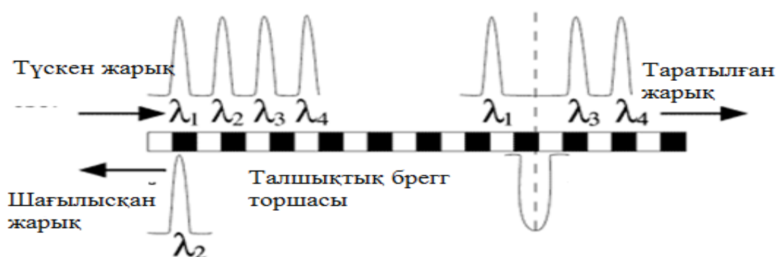
2.2 Сурет - Fiber Bragg торы композиттік сигналдан белгілі бір толқын ұзындығының арнасын шығарады
